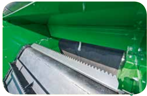
Befüllung der Presskammer
