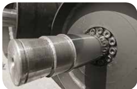
Presskammerwalzen mit durchgehender Welle und austauschbaren Verschleißbuchsen
