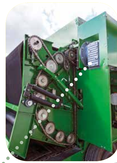
Direktantrieb der Presskammer
