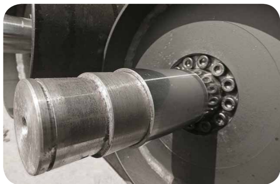
Presskammerwalzen mit durchgehender Welle und austauschbaren Verschleißbuchsen
